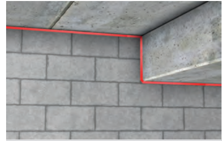
Złącze konstrukcyjne ściany ze stropem
